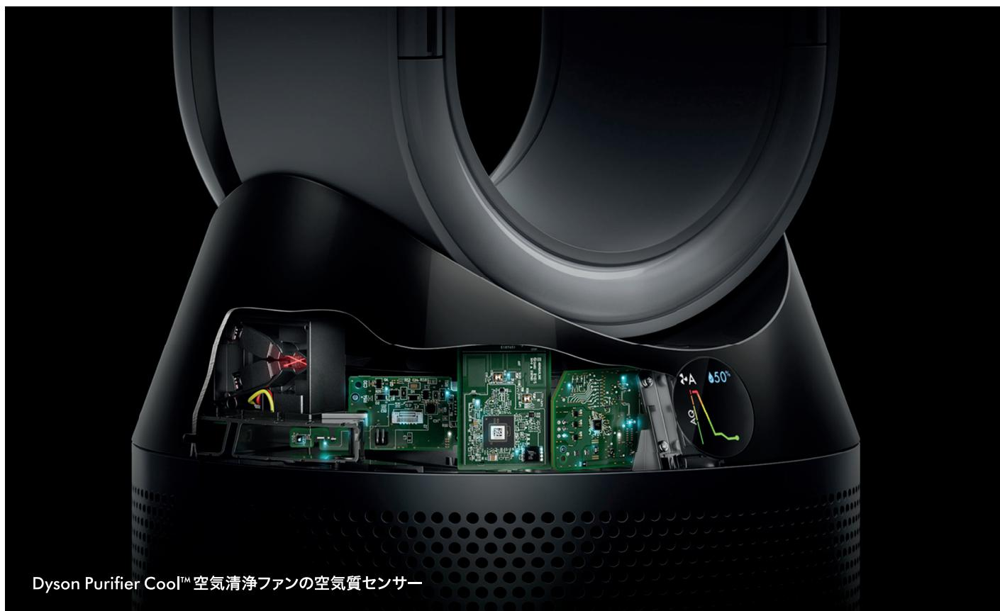
Dyson Purifier Cool™ 空気清浄ファンの空気質センサー
